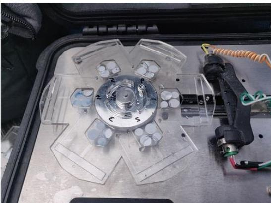
*Disco de microfluidos centrífugo que actúa como un laboratorio móvil.*
