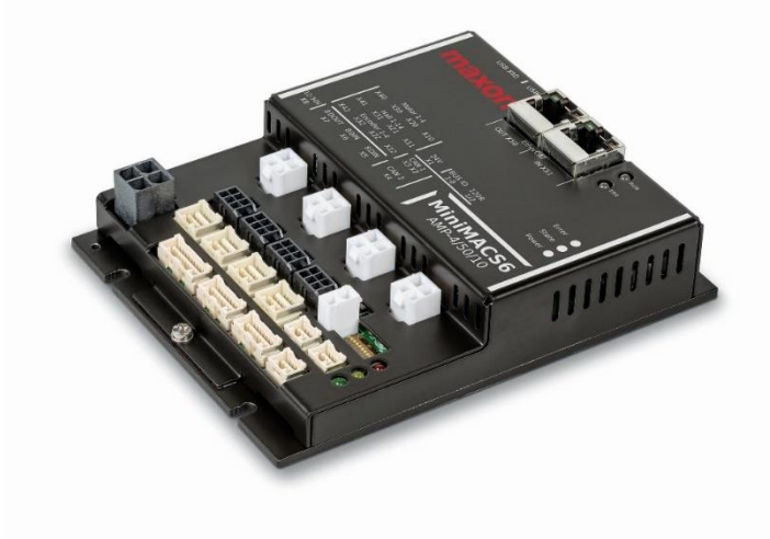
MiniMACS6-AMP-4/50/10-IF1 (IF1: con tarjeta opcional EtherCAT Slave)
