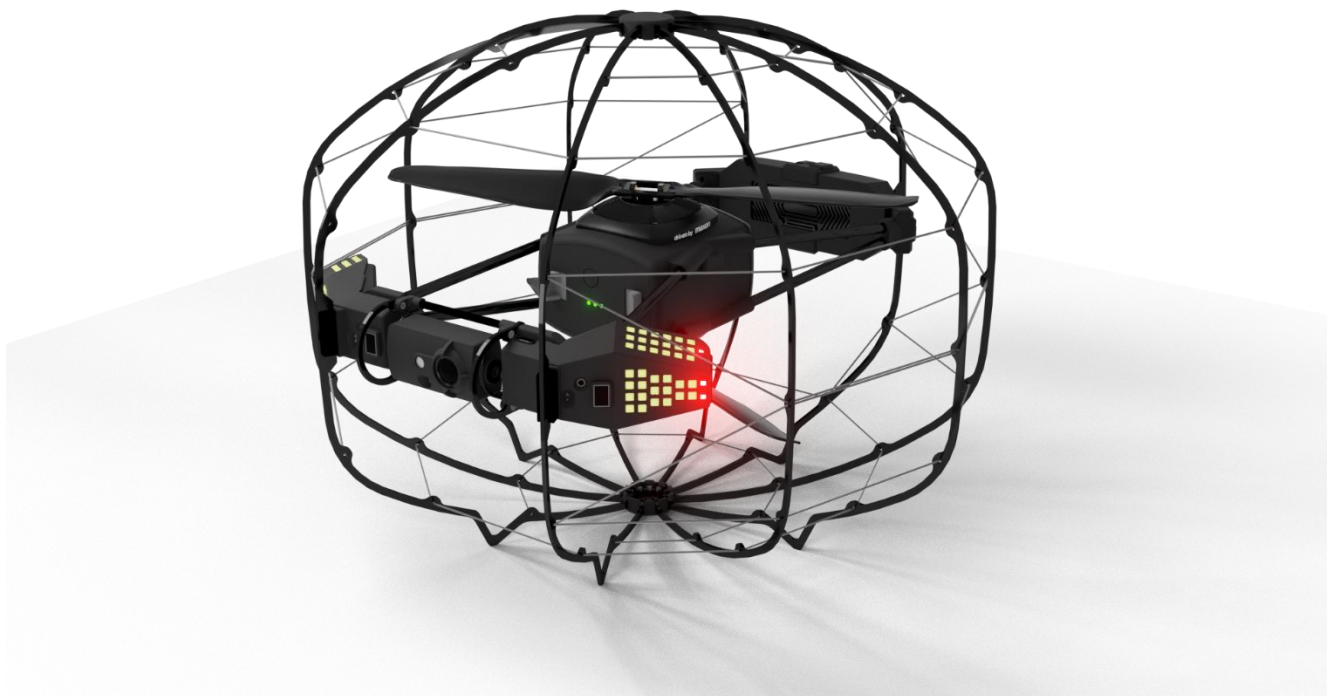
El dron de inspección ASIO de Flybotix.
