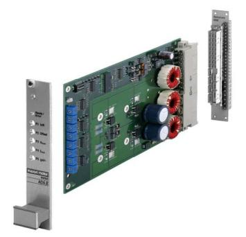
Grâce à l'utilisation de transistors de puissance MOS-FET, son rendement atteint 95% à la puissance nominale. Le variateur est muni d'une self de lissage permettant de réduire les ondulations du courant dans le circuit moteur. La fréquence de découpage PWM est de 50 kHz, elle permet de piloter les moteurs à basse inductivité. Une self externe peut ainsi être évitée dans la plupart des applications.
