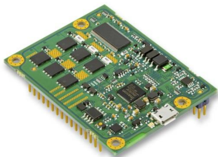
EPOS4 Module 50/8 (59,5 x 46,0 x 14,1 mm) Módulo de control de posición OEM, adecuado para motores DC con encoder, así como para motores brushless con sensores Hall y encoder hasta 400/1500 W. © 2016 maxon motor
